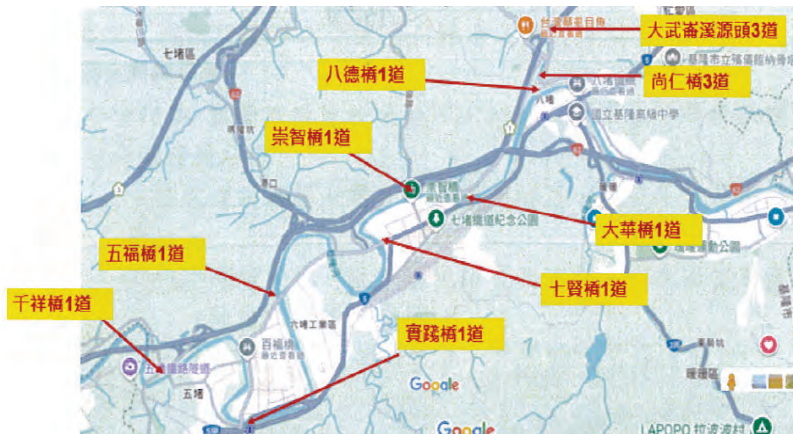
圖 9 台灣中油公司大武崙溪柴油污染事件攔油索布置
