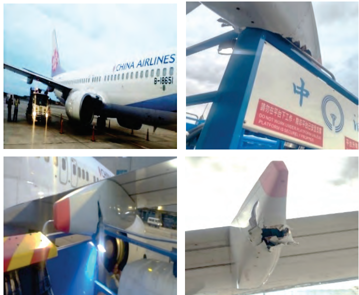
圖 13 台灣中油公司油栓車擦撞飛機右翼下方襟翼滑軌整流罩事故現場
