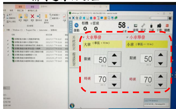
圖2 於速限50公里路段設定啟動設備拍攝時速為70公里
