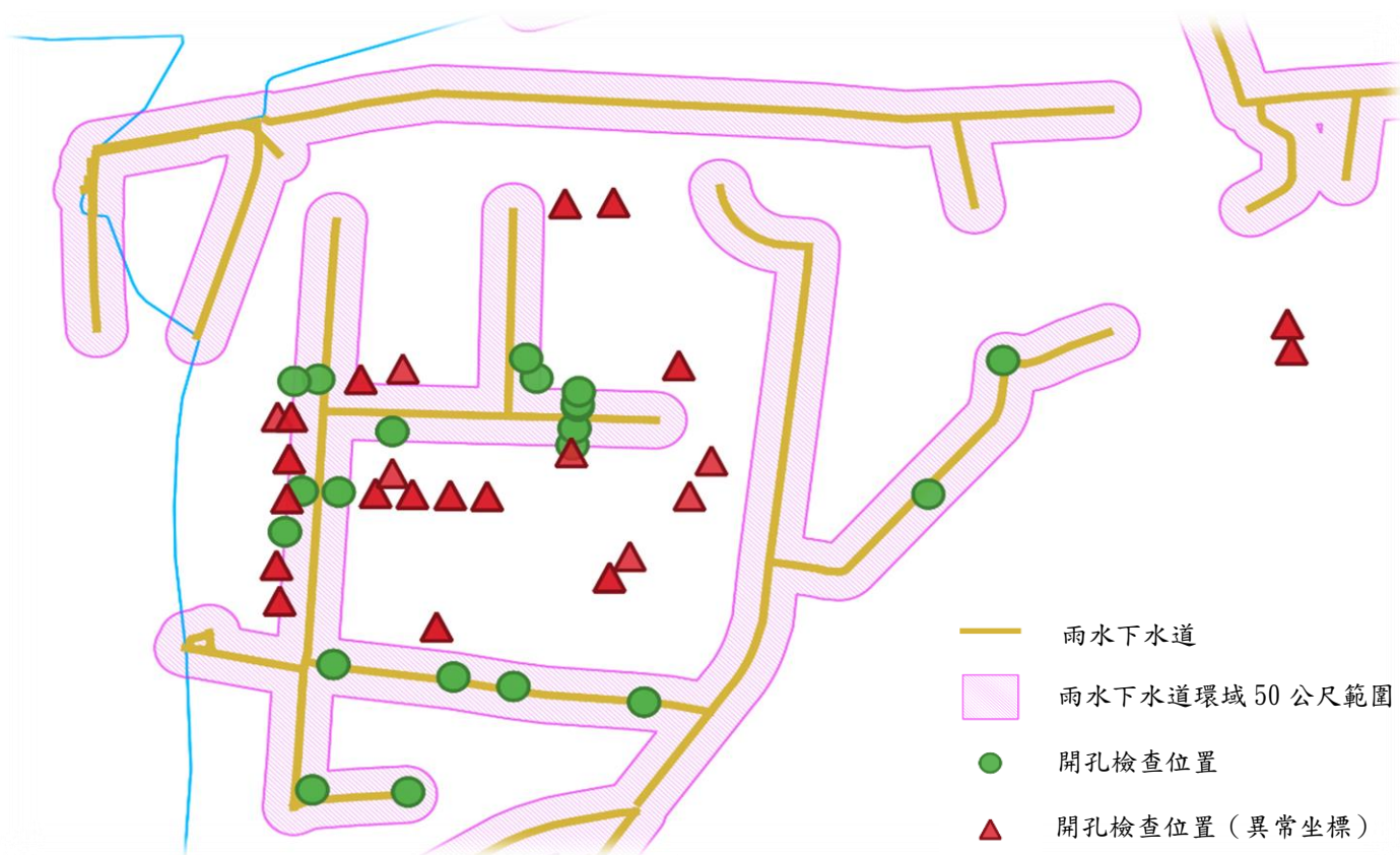
圖 3 仁德區雨水下水道開孔檢查坐標與下水道圖資套疊示意
