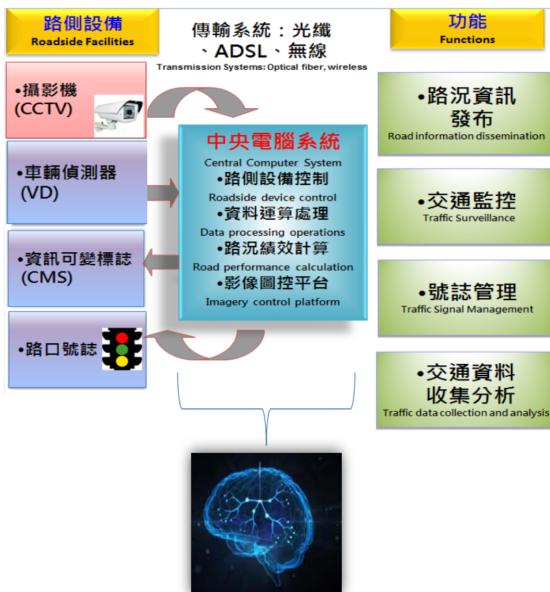
圖 2 臺北市交通監控系統架構
