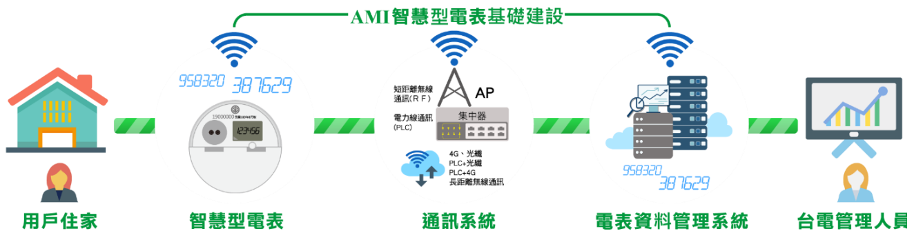
圖 7 AMI 智慧電表基礎建設運作模式
