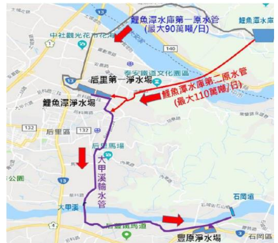
圖 5 大安大甲溪聯通管配置暨大甲溪高濁度之水源調配示意
