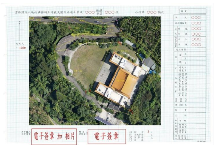
圖 21 UAV 真正射影像圖套疊地籍圖實務應用情形
