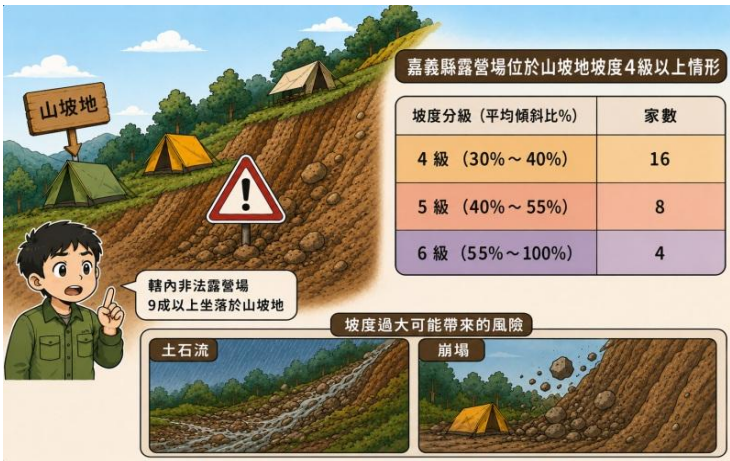
圖 12 嘉義縣露營場位於山坡地坡度 4 級以上情形
