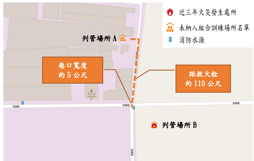
圖 3 列管場所位於狹小巷弄、距救火栓較遠或曾發生火災情形
