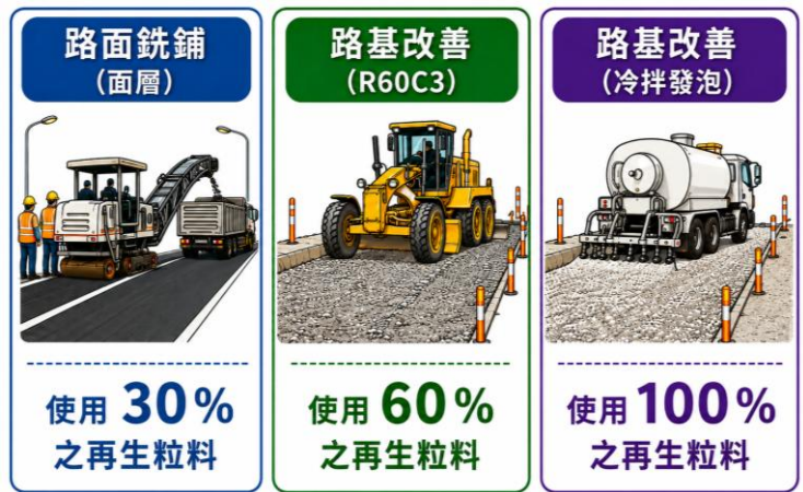
圖 13 再生瀝青混凝土道路施工工法
