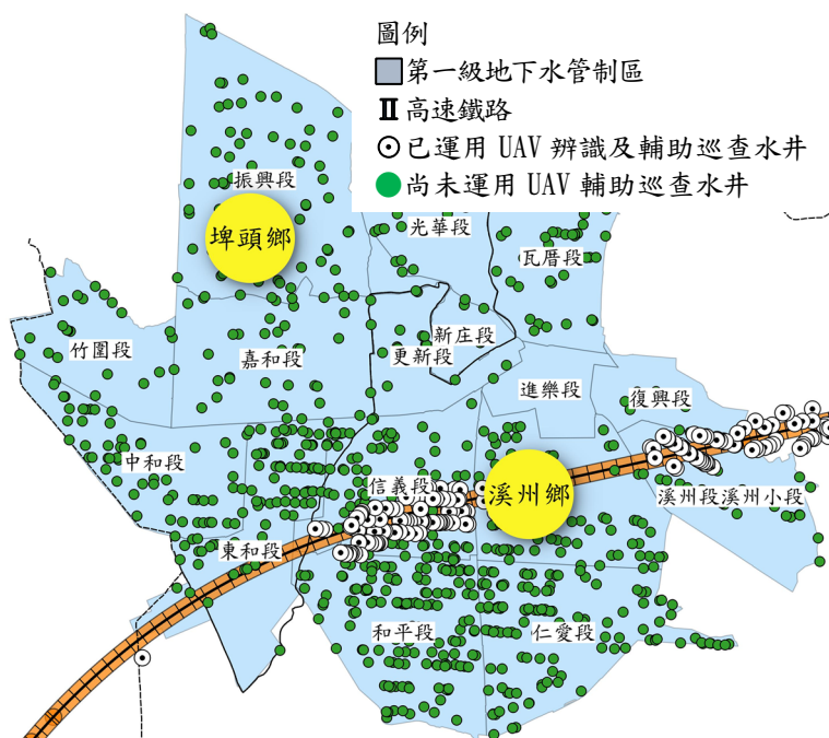
圖 7 部分第一級地下水管制區尚未納入監測範圍
