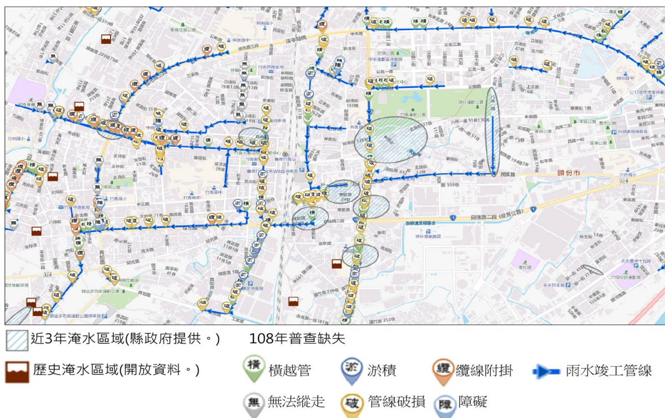
圖 14 頭份竹南地區 108 年雨水下水道普查缺失與 111 至 113 年發生淹水事件區域分布
