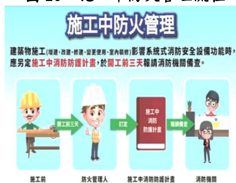
圖 26 施工中防火管理流程
