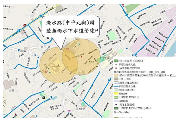
圖 3 易淹水區周邊 200 公尺範圍內尚未 建置雨水下水道
