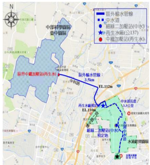
圖 2 水滄水資源回收中心 BTO 案營運範圍及輸水系統
