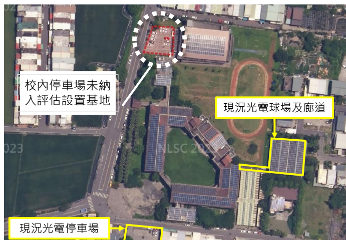
圖 19 五結國中太陽能光電設備設置情形
