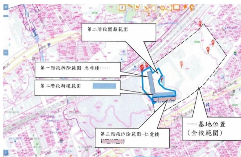
圖1 秀峰高中老舊校舍拆除及新建三階段施工情形
