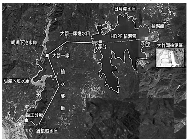
圖 16 日月潭水庫水力發電排砂計畫
