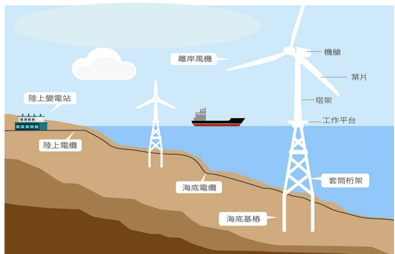
圖 5 離岸一期風場組成結構示意
