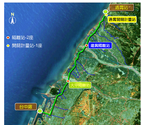
圖 4 台中廠至通霄站路上輸氣管線路徑圖
