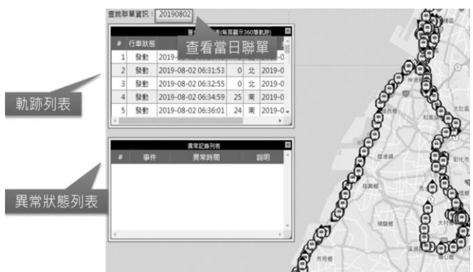
圖 3 危險物品車輛動態系統功能示意
