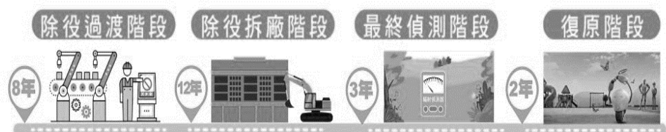
圖 1 核能發電廠除役 4 階段
