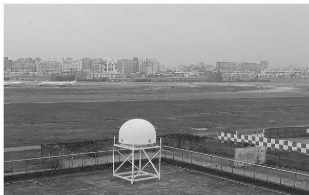
圖 2 臺北國際航空站無人機射頻偵測系統
