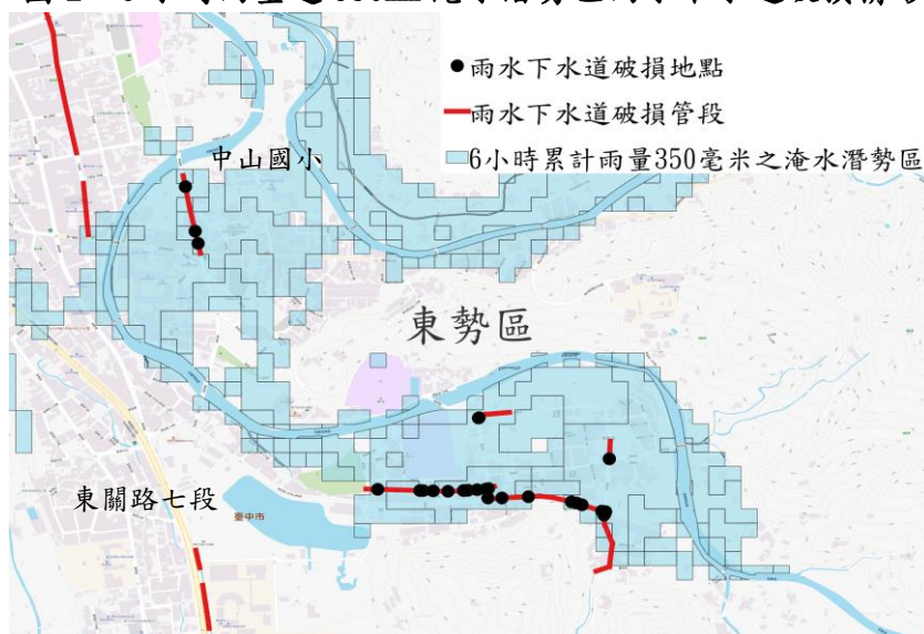
圖 2 6 小時雨量達 350mm 淹水潛勢區雨水下水道破損情形
